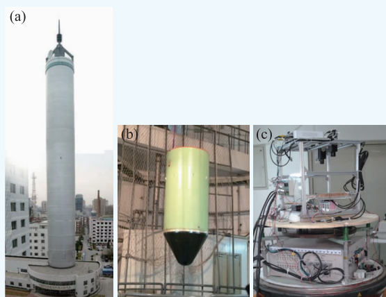
图3 (a)国家微重力实验室落塔;(b)落舱;(c)实验装置
