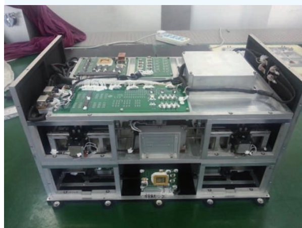
图2 实践十号颗粒物质箱的三层结构:上层为电控装置,中层为双仓实验模块层,下层为单仓实验模块层
