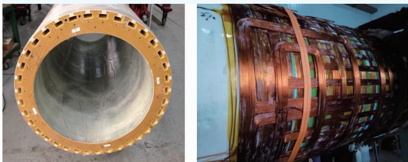
图10 (a)制作完成的9.4 T梯度线圈；(b)绕制中的匀场线圈
