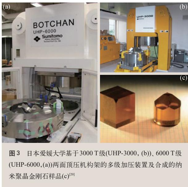
图3 日本爱媛大学基于3000 T级(UHP-3000, (b))、6000 T级(UHP-6000, (a))两面顶压机构架的多级加压装置及合成的纳米聚晶金刚石样品(c)<sup>[20]</sup>
